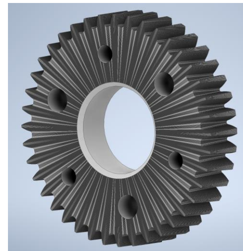
Zahnradkörper mit hinzugefügten Bohrungen
